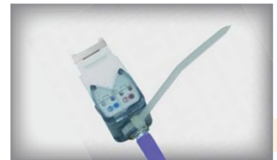
束帶拉緊固定後剪除多餘束即完成
